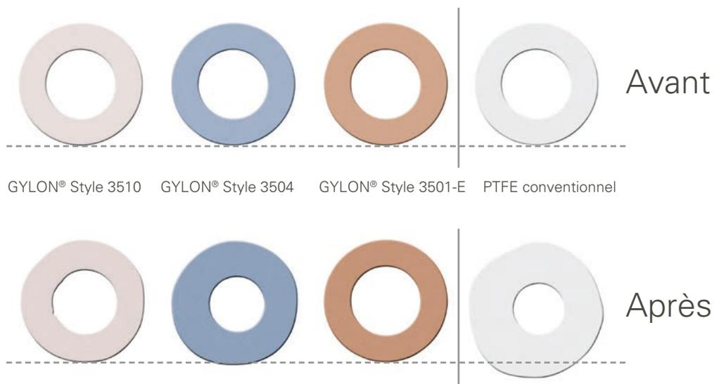
Comparaison entre les joints plats GYLON® et le PTFE non chargé après une charge de compression de 14 MPa pendant une heure à une température de 260°C.
