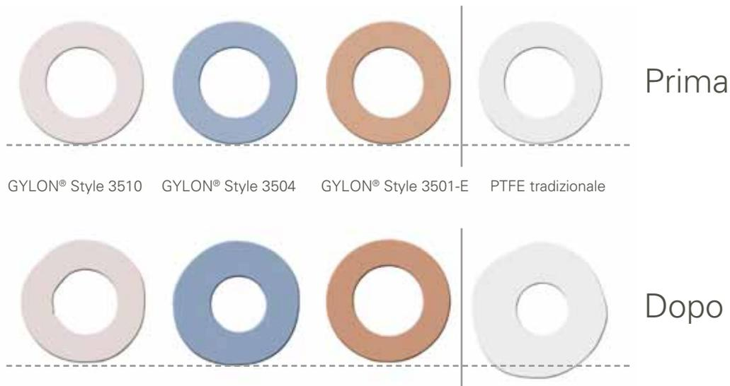
Confronto tra guarnizioni piane GYLON® e PTFE non caricato, dopo essere state sottoposte per un'ora a un carico di compressione di 14 MPa a una temperatura di 260 °C.
